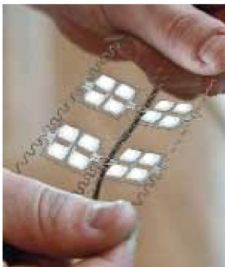
Genom en meanderformad struktur mellan tryckta eller ultratunna och stela komponenter har forskarna lyckats skapa en folien med elektroniken som blir töjbar.
