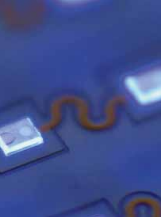
En tryckt krets som byggs upp av flera skikt genom att man alternerar mellan att använda ledande och isolerande bläck. Krets på bilden har fyra lager, närmast arbetar forskarna med att skapa kretsar med sex lager.
